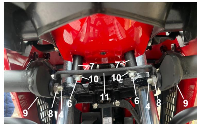
FIGURA 2 - FLANGE JUNÇÃO DIANTEIRA
