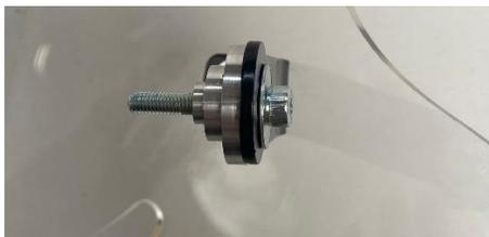
4° - FIXAR O PARABRISA AOS SUPORTES SUPERIORES CONFORME ESQUEMA ABAIXO. **NÃO REALIZAR O APERTO TOTAL.**
